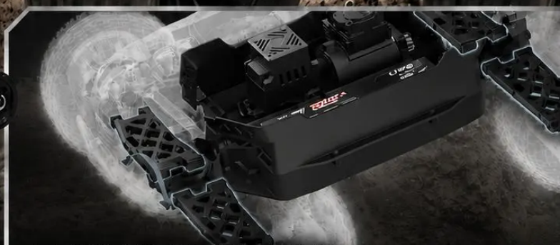
WZMOCNIONE RAMIONA ZAWIESZENIA NYLONOWE
