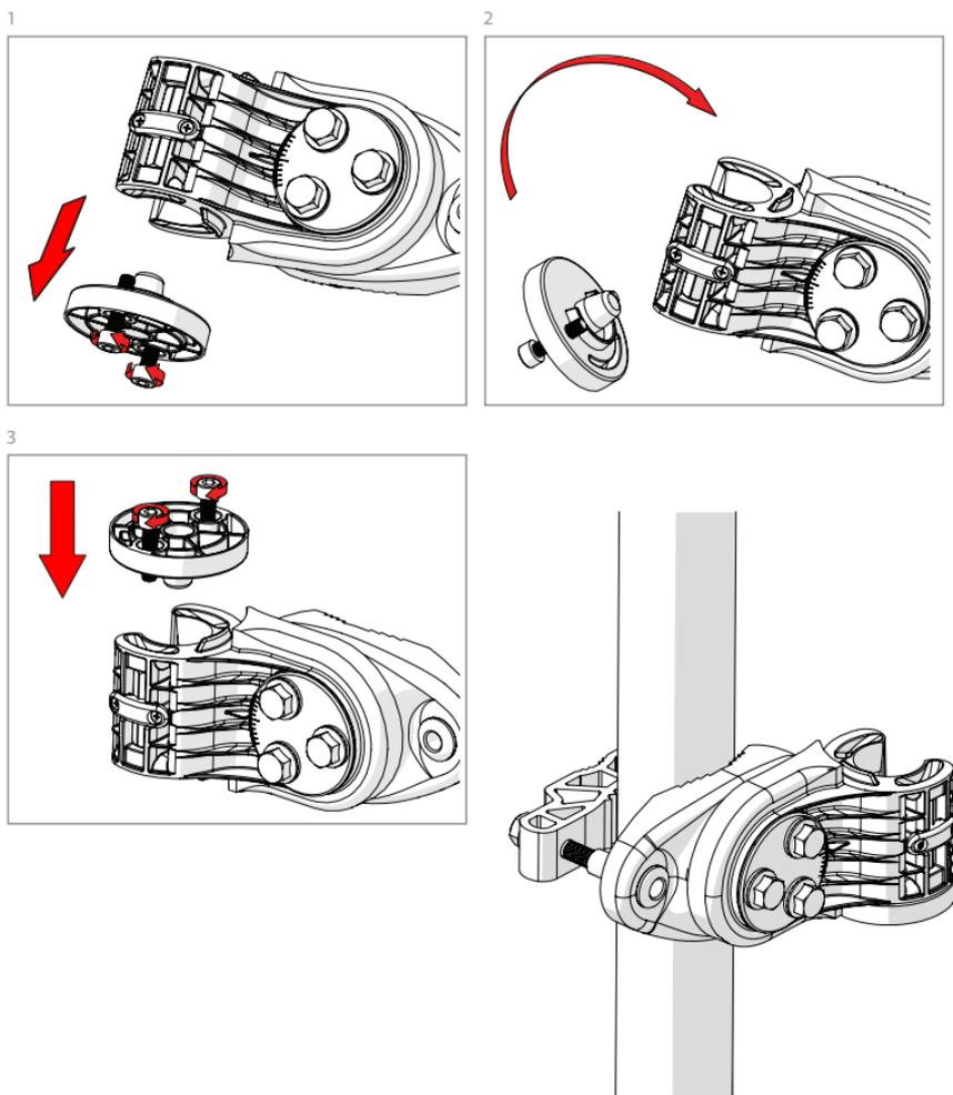
Mostrado modelo ULD-TP-400-4PACK. Las instrucciones de instalación son idénticas para ULD-TP-550-4PACK. Las dimensiones de la antena pueden variar.
