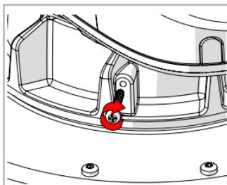
Apriete el tornillo de bloqueo para asegurar el mecanismo de bloqueo del TwistPort™
