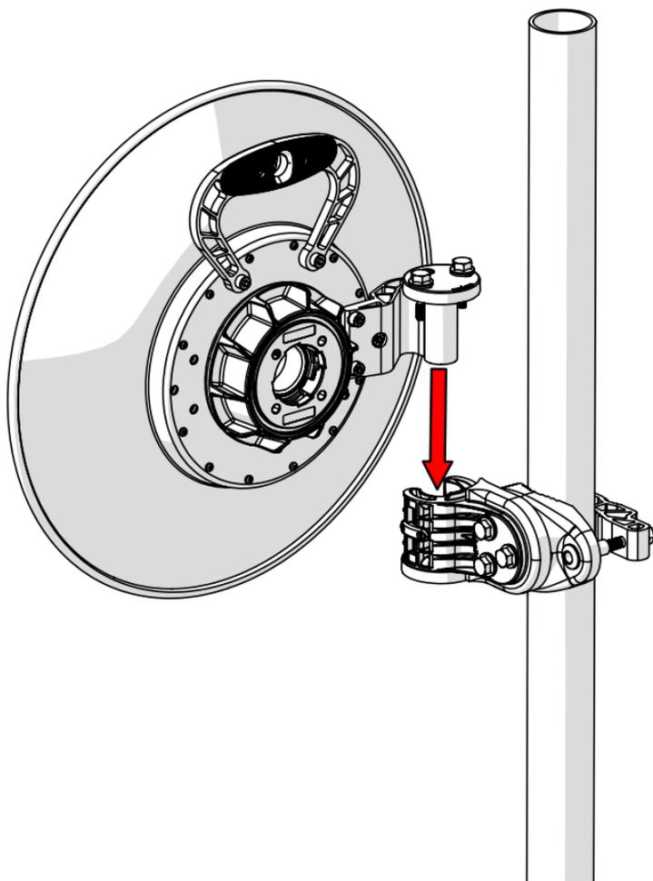
Mostrado modelo ULD-TP-400-4PACK. Las instrucciones de instalación son idénticas para ULD-TP-550-4PACK. Las dimensiones de la antena pueden variar.
